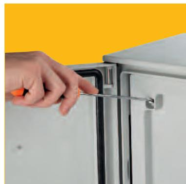
Il sistema di aggancio rapido delle controporte è costituito da due perni in acciaio inox a molla: permette la reversibilità della porta ed il posizionamento su due distanze diverse dalle portelle
